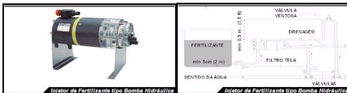
Figura 19 – Injetor de fertilizante tipo bomba hidráulica e esquema de instalação
