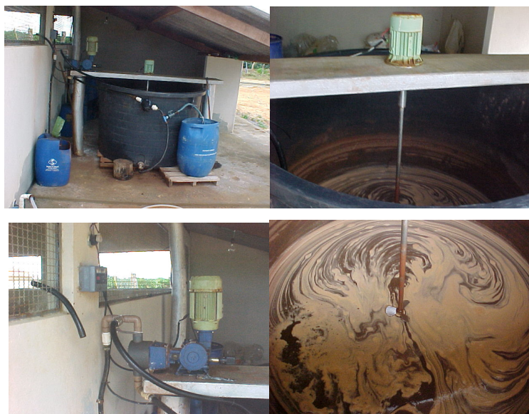
Figura 20 - Sistema de injeção de fertilizantes para fertirrigação com bomba de injeção e pá misturadora.
