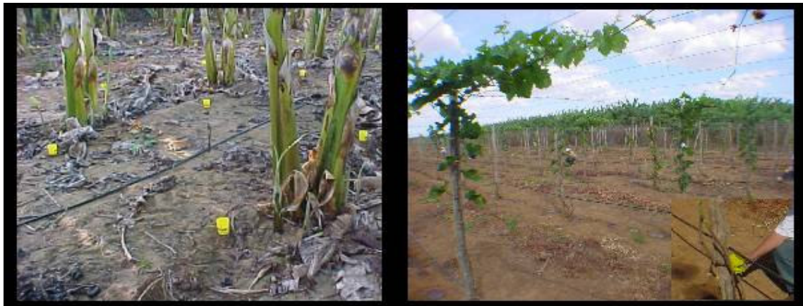
Figura 7 – Distribuição dos coletores para a realização de um teste de uniformidade nas culturas da bananeira e videira.
