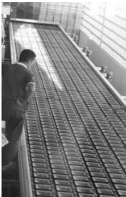
Figura 4. Equipamento utilizado na classificação de mangas. As caçambas com as frutas desarmam, deixando as frutas caírem em diferentes esteiras, de acordo com seu peso.
