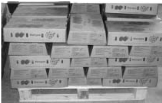
Figura 6. Embalagens de papelão para mangas, com formato trapezoidal, de difícil paletização e manuseio.
