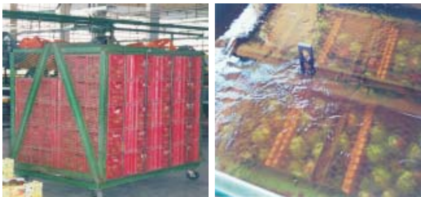
Figura 5. Gaiola contendo as caixas de mangas (à esquerda) e as frutas imersas em água aquecida a 46.1 °C (à direita) para controle das moscas-das-frutas
